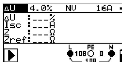
Bild 5.276\*: Spannungsfall
