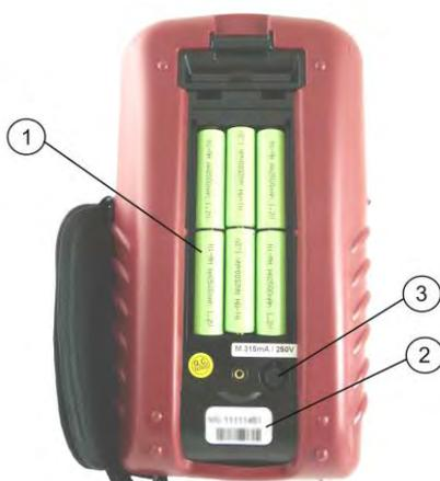
Bild 3.4: Batteriefach
