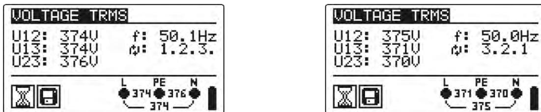
Bild 5.4: Beispiel für eine Spannungsmessung im Drehstromnetz
