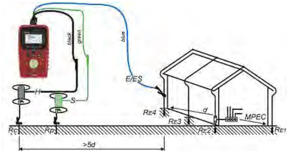
Bild 5.34: Widerstand zu Erde, Messung einer Blitzschutzanlage
