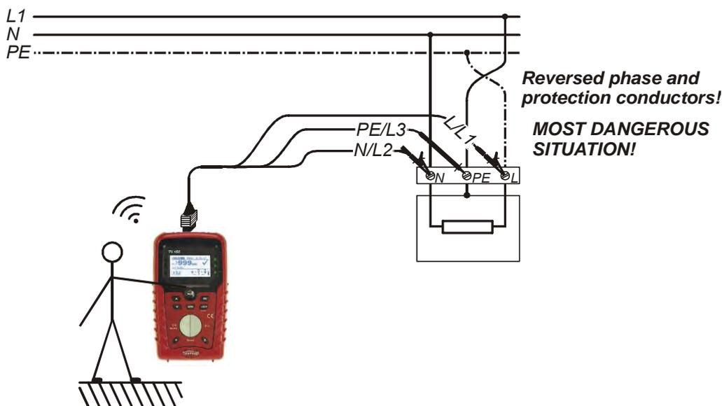
Bild 5.37: Vertauschte Leiter L und PE (Anwendung des Universalprüfkabels)
