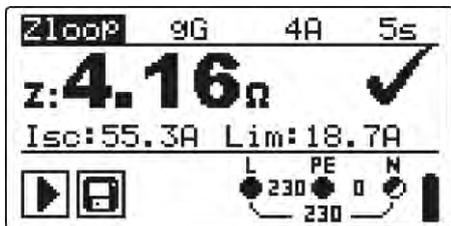
Bild 3.5: Typisches Funktionsdisplay
