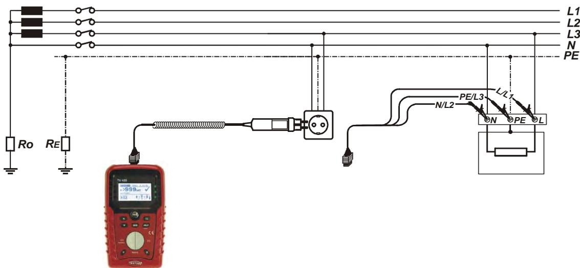
Bild 5.24: Anschluss des Steckerkabels und des Universalprüfkabels
