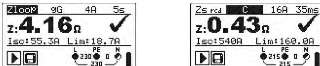
Bild 5.25: Beispiele für Messergebnisse der Schleifenimpedanz
