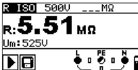
Bild 5.7: Beispiel für ein Ergebnis einer Isolationswiderstandsmessung
