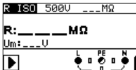
Figura 5.5: Resistencia de aislamiento
