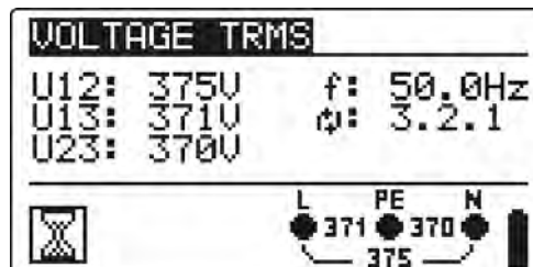
Afbeelding 5.4: Voorbeelden van spanningsmeting in driefasensysteem
