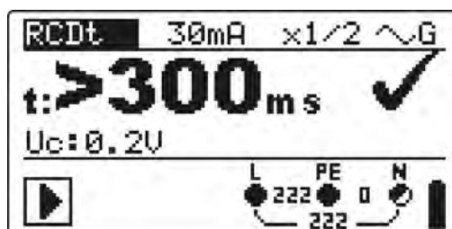
Rysunek 5.19: Przykład wyników pomiaru czasu wyłączenia
