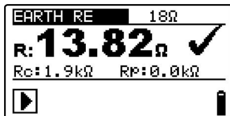
Rysunek 5.32: Przykładowy wynik pomiaru rezystancji uziemienia
