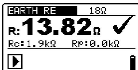
Afbeelding 5.32: Voorbeeld van het meetresultaat van de aardweerstand
