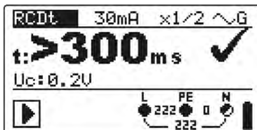
Figura 5.19: Ejemplo de medición del tiempo de desconexión
