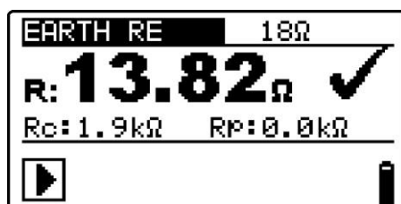
Figur 5.32: Exempel på resultat från mätning av jordmotstånd
