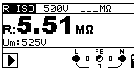
Rysunek 5.7: Przykładowy wynik pomiaru rezystancji izolacji
