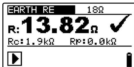
Figura 5.32: Ejemplo de resultado de la medición de la resistencia de tierra
