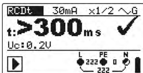
Figura 5.19: Esempio di risultati di misurazione del tempo di trip-out
