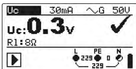
Afbeelding 5.18: Voorbeeld van de meetresultaten van de aanraakspanning
