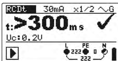
Afbeelding 5.19: Voorbeeld van de meetresultaten van de uitschakeltijd
