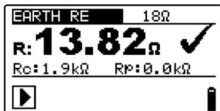
Figura 5.32: Esempio di risultato della misurazione della resistenza di terra
