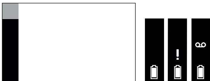
Figuur 15: Statusvak (zwart) - Links: Statusvak - Rechts: Voorbeelden van informatie over huidige situatie (hier: Resterende batterijcapaciteit, Instrumententest noodzakelijk, Registratie)
