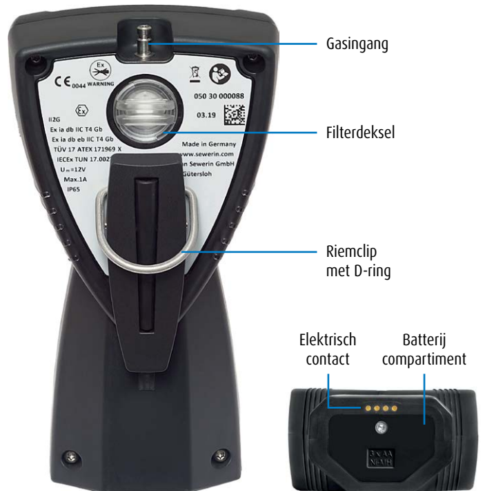
Figuur 2: Achterzijde (afbeelding links) en onderzijde van het instrument met batterijcompartiment (afbeelding rechts)
