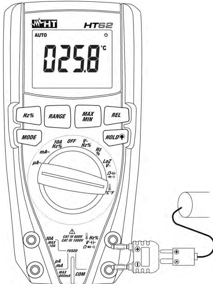
Fig. 9: Uso del instrumento para medida de Temperatura
