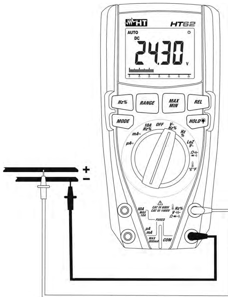
Fig. 2: Uso del instrumento para medida de Tensión CC
