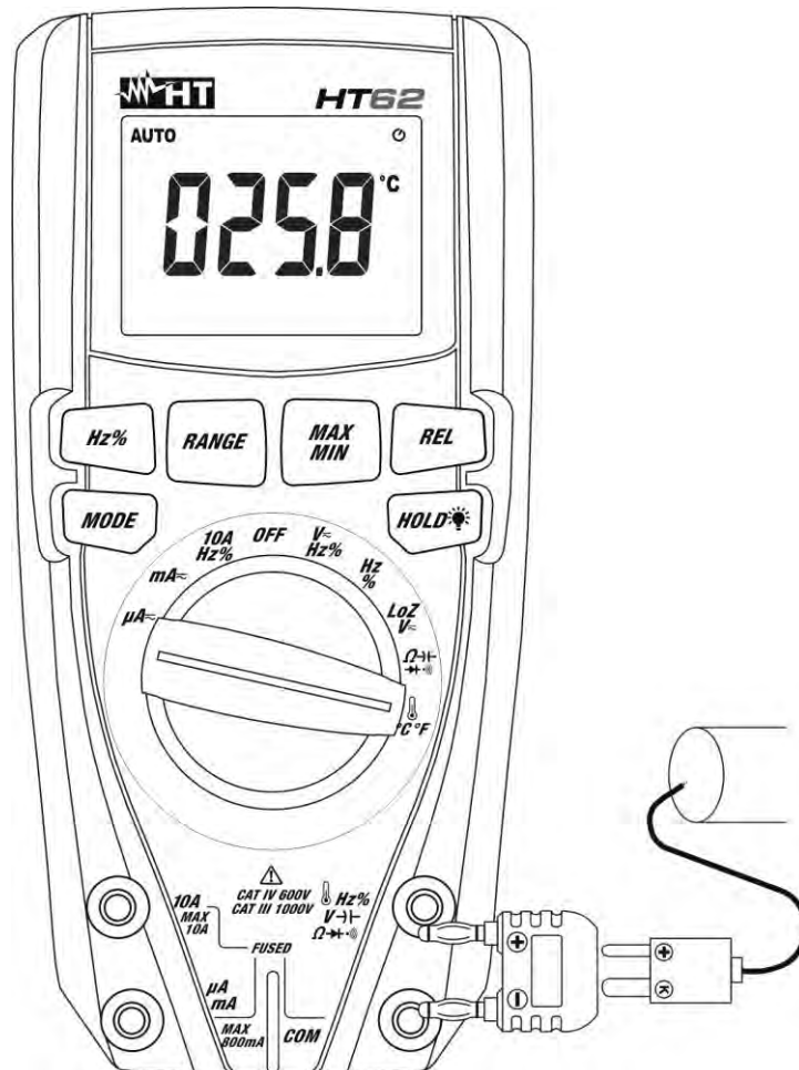
Fig. 9: Uso dello strumento per misura di Temperatura
