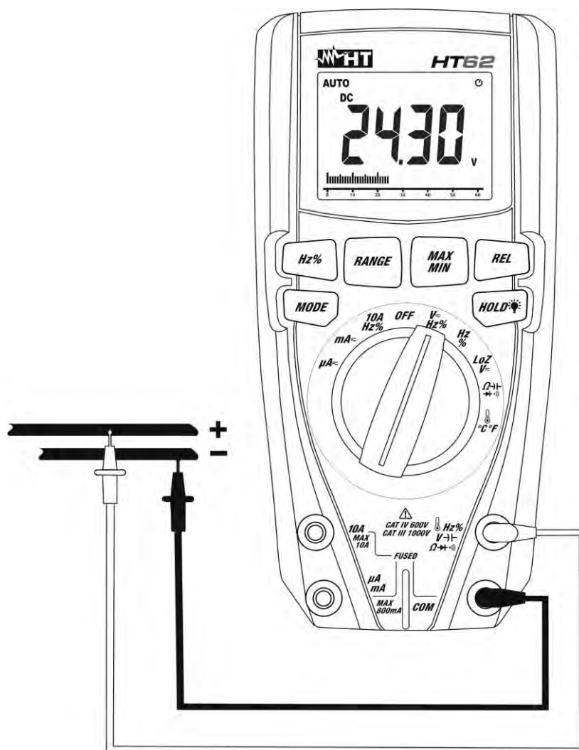
Fig. 2: Uso dello strumento per misura di Tensione DC
