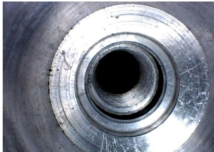
Foto boven: Inspectie van een bougiepoort
