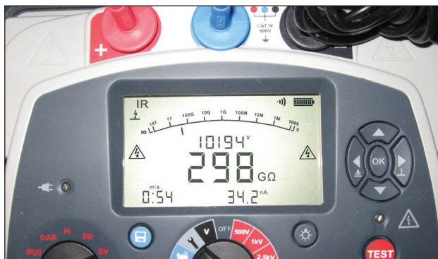
Afbeelding 8: bovenpaneel en schermweergave van Megger MIT1025
