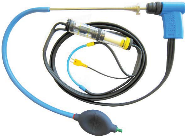
fig. 10: Meetopstelling met monstername dichtheidscontrolezet
