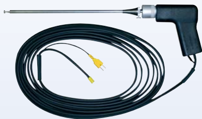
300 mm rookgasprobe (600 °C/15 min.) met 6 meter monsternameslang. (uitsluitend voor Nederland)
