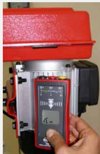
Draadloze detectie van motorrotatie
