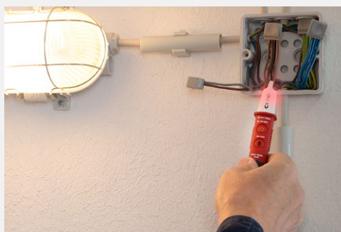
Testen van draden voor AC-spanning voor het snel lokaliseren van problemen
