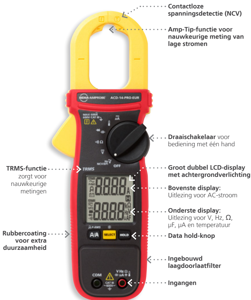
ACD-14-PRO-EUR 600 A TRMS-stroomtang-multimeter met dubbel display
