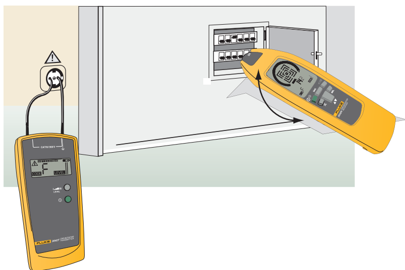
Afbeelding 3 - Voorbeeld van de toepassing van het lokaliseren van elektrische circuits naar veiligheidsapparaten zonder het systeem uit te schakelen.
