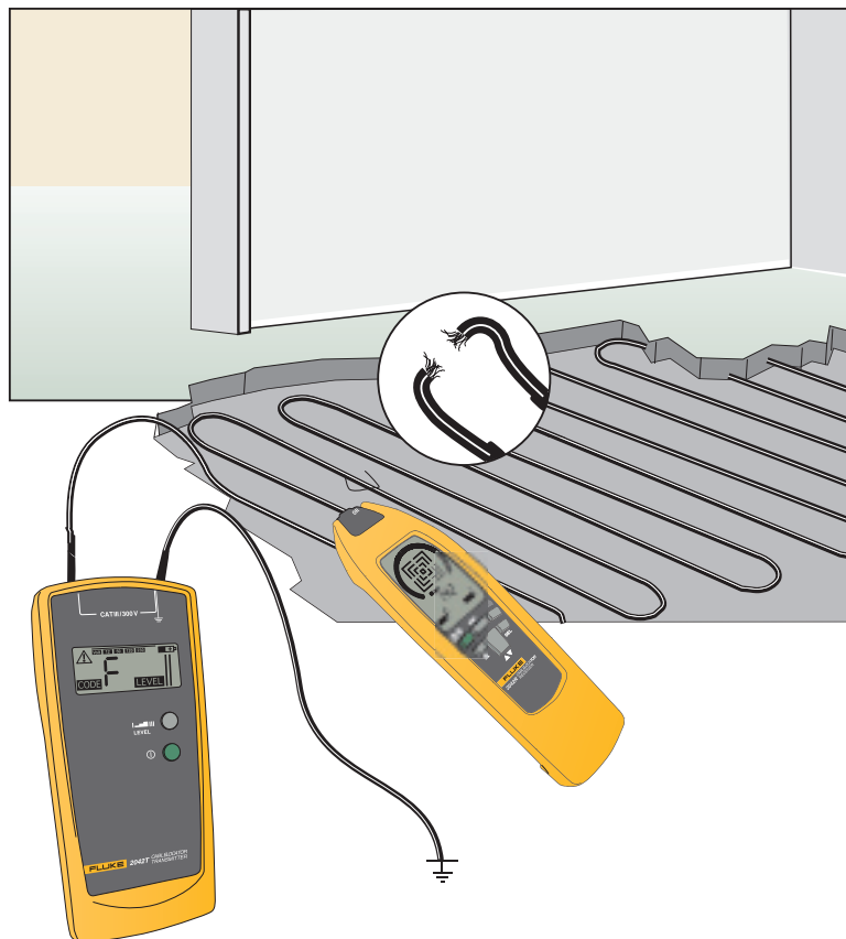
Lokaliseren van fouten in elektrische vloerverwarming.
