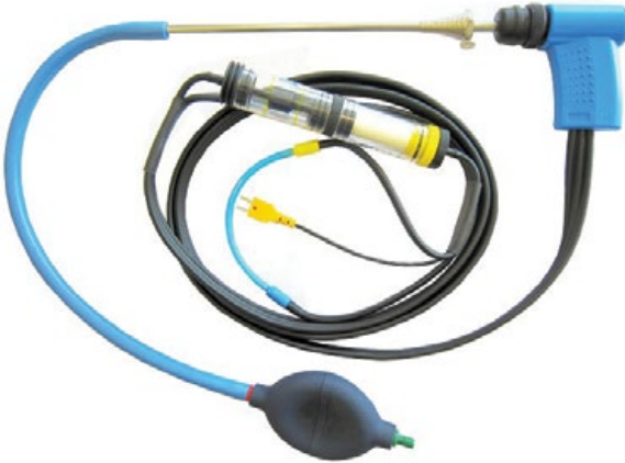
fig. 6: Meetopstelling met monstername dichtheidscontrolezet
