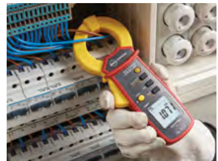
Differentieelstroommeting met lekstroomklem
