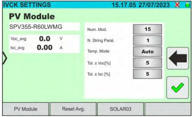
Fig. 48: IVCK test parameter settings
